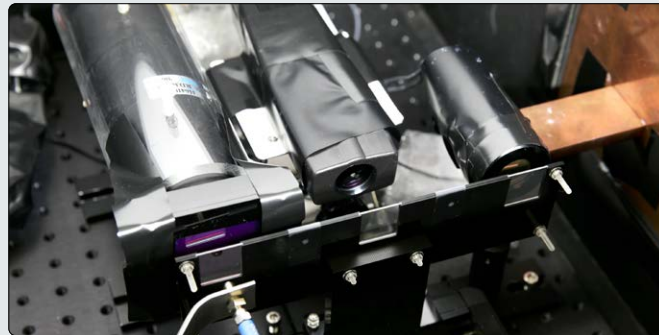
LHCf実験で用いられる超小型サンプリングカロリメータ較正試験。 A test bench built for ultra-small sampling calorimeter elements for the LHCf experiment.
