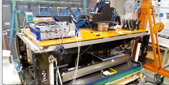
世界最高速の原子核乾板飛跡読み取り装置。 毎時0.45m 2 の処理能力を実現した。 Implementation of the world's fastest nuclear emulsion readout system, achieving a readout throughput of 0.45 m 2 /h.
