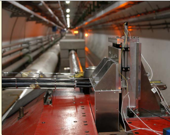
LHC加速器トンネル内に設置されたLHCf検出器 Detector for the LHCf experiment installed at the LHC tunnel
