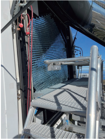
図：LST 初号機カメラをモジュール交換のため開けたところ
