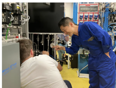
写真 2 XENONnT 検出器サブシステムのリークチェック作業。（現地技師の F. Alfonsetti 氏と作業）
